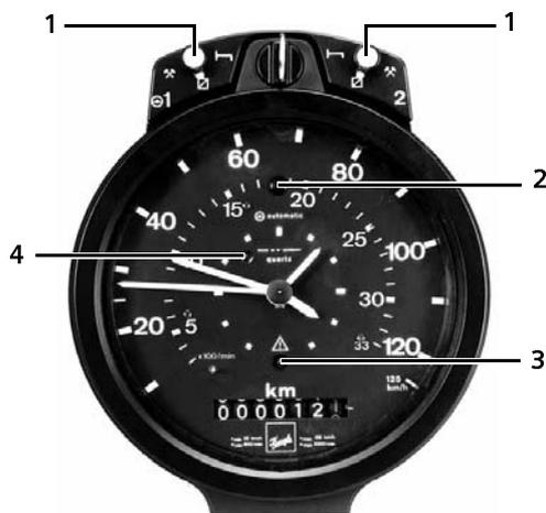
Abb. 1: Automatik-Ausführung 1311/1314; 1+2-Fahrer
